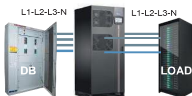
Installation à 4 câbles (L1-L2-L3-N)
